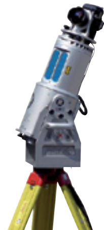
Mittelbereich: Terrestrischer 3D-Laser-Scanner. Auflösung: ca. 5-10 mm
