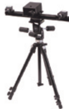
Nahbereich: Streifenlichtscanner & Computertomographie. Auflösung: 0,07-0,1 mm
